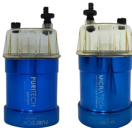
**Tecnologia:** Nanotecnologia de filtragem de 1 a 5 micras, sendo apolar e hidrofóbica, usamos componentes de base inorgânica como fibras e resina melamínica, não sendo agressivas ao meio ambiente. Corpo produzido com Alumínio 7075, que tem alta resistência contra fadiga estrutural, são leves, resistentes a oxidações e não reagem com combustível. O-rings de vedação fabricados em Nitrílico que resistem a altas pressões e a combustíveis.
